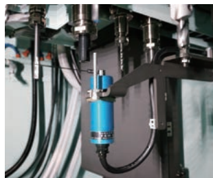
刃具折損検知装置(NC可動式センシングヘッド) Tool breakage sensor(NC moving type sensing head)
