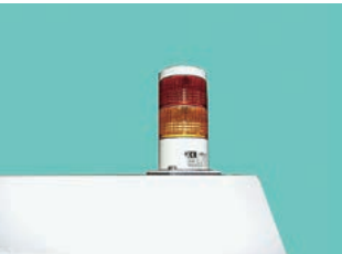
シグナルタワー Lamp for cycle finish and alarm
