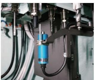
刃具折損検知装置(NC可動式センシングヘッド)
