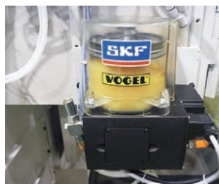
グリス集中潤滑(自動) Centralized lubrication (Automatic)
