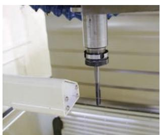
刃具折損検知装置(LS式)
