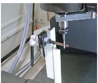
刃具折損検知装置(タッチ式)
