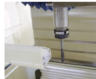
刃具折損検知装置(LS 式) Tool breakage sensor(LS type)
