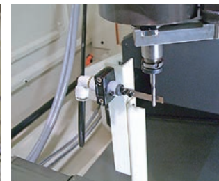
刃具折損検知装置(タッチ式) Tool breakage sensor(fixed type)
