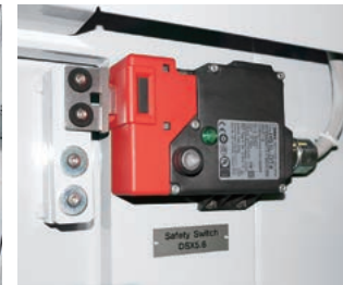
ドアインターロック(電磁ロック式) Door interlock(Magnetic lock type)
