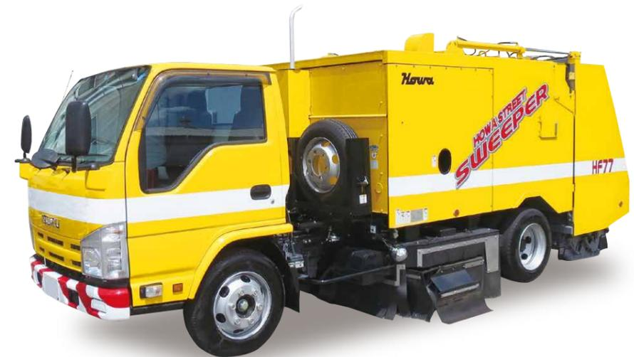
小型のトラックシャシに架装し、価格、性能面での優位性を実現しました。世界初のホッパリフト方式の採用により塵埃排出作業時において積替え用ダンプへの接近が容易で、安全に作業を行えます。また、給脂箇所の少ないシンプルなリフト機構とすることで、保守点検の容易さに配慮しました。
