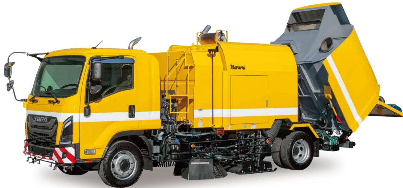
9トン積トラックシャシに架装した4輪真空還流式路面清掃車です。還流する空気流により塵埃はホッパに回収され、ダストセパレータにより細かい塵埃も外部に出さないクリーンな清掃作業ができます。
