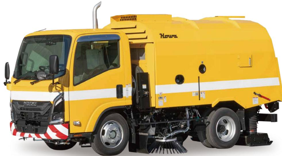
小型トラックシャシへ架装されており、小回りがきき、かつコンパクトなため、狭い道路の清掃にも適し、安全で容易な運転操作ができます。小型ながら、清掃幅が広いので効率の良い作業ができます。
